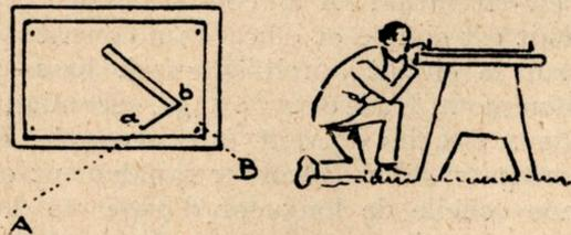
FIG. 4. — Les visées à la règle, après avoir amené l'un des points représentatifs de la base au-dessus du point réel et après avoir orienté la planchette de façon que la ligne représentative de la base se confonde avec celle-ci.
